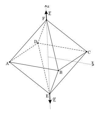
Déterminer successivement la tension dans les barres horizontales, puis la tension dans les barres inclinées, en utilisant le PPV. L'idée est de chercher des mv particuliers qui permettent, par application du PPV, d'atteindre directement l'inconnue recherchée. Il s'agit donc de proposer un mv qui rigidifie la partie de la structure qui ne nous intéresse pas, c'est-à-dire tel que la restriction à cette partie de la structure soit un mvr.
